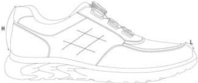
图3 成品尺寸测量部位示意图
