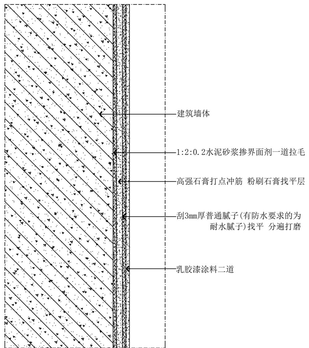
a 剖面图 墙面乳胶漆标准大样
