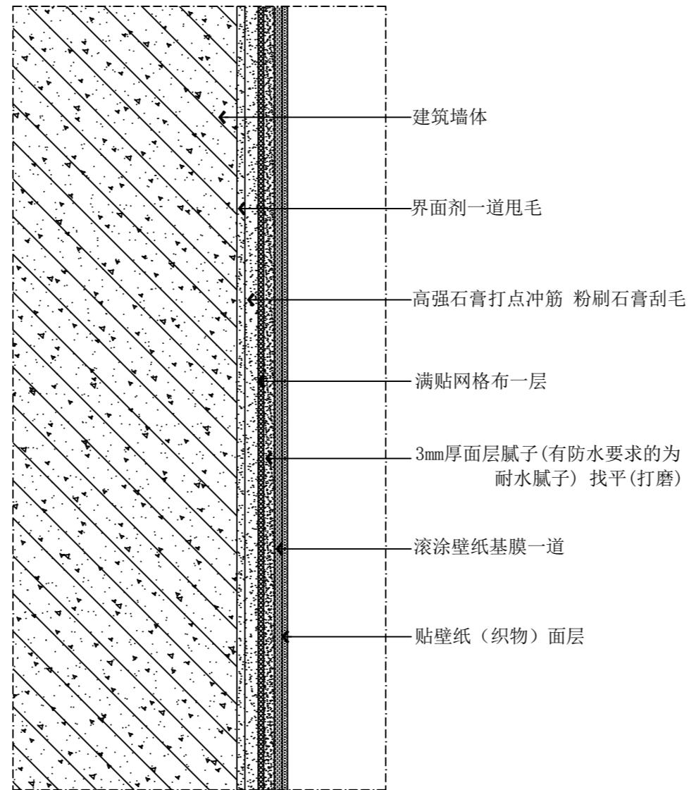
b 剖面图 墙面壁纸标准大样
