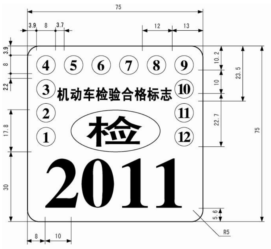
图 A.1 正方形机动车检验合格标志正面
